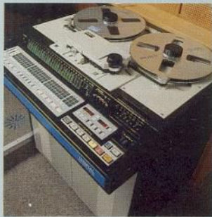
Die Sony 24-Kanal-Maschine PCM-3324 für Mehrkanalaufzeichnung einzelner Instrumente und Stimmen.
