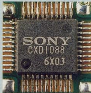
Der Sony LSI-Chip der dritten Generation bietet zusammen mit 16-Bit-4fach-Oversampling und Digitalfilter hohe Zuverlässigkeit, präzise Signalverarbeitung und optimale Klangqualität.
