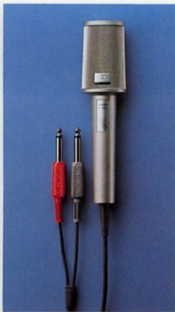
F-99 A Dynamisches Stereo-Mikrofon in One-Point-Ausführung mit 2 Kapseln. Nierencharakteristik für beide Kanäle. Ausgezeichnete Kanaltrennung. Übertragungsbereich: 80 bis 12.000 Hz.
