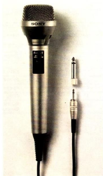
F-V 3 T Dynamisches Mikrofon mit Nierencharakteristik. Übertragungsbereich: 100-12.000 Hz.
