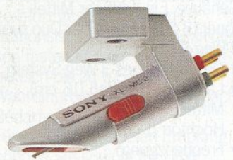
XL-MC 2. Wie XL-MC 1, jedoch mit konischem Aluminium-Nadelträger für höhere Steifigkeit, weniger Verzerrungen und minimale Resonanzen. 10–45.000 Hz.
